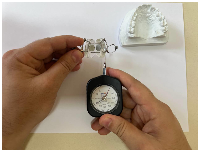
Рис. 5. Методика измерение силы расширяющего винта или магнита.
