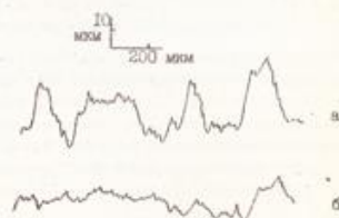
Рис. 5. Профилотграммы поверхности твердой ткани зуба, препарированной а) имплантированным и б) неимплантированным бором.
