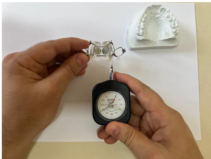
Рис. 5. Методика измерение силы расширяющего винта или магнита.
